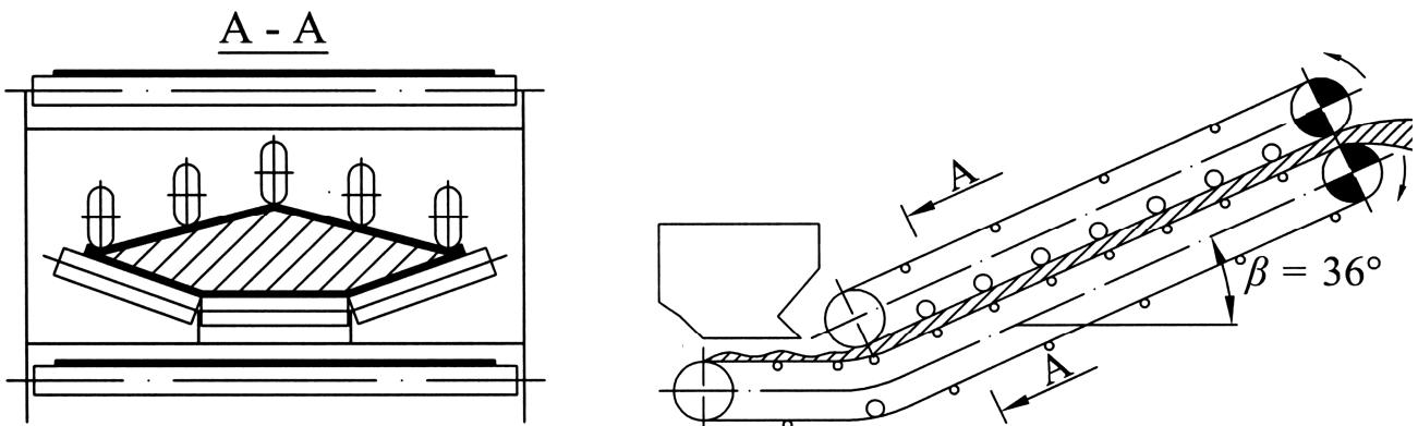
*Рис. 1. Схема крутонаклонного конвейера с прижимной лентой*
